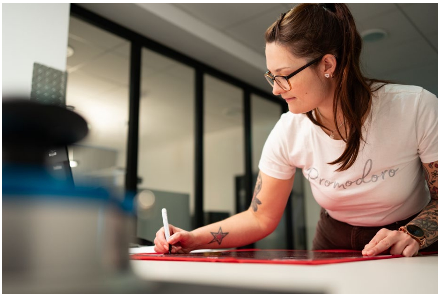
Christina vérifie les valeurs de rétrécissement à l'aide du gabarit de rétrécissement normalisé selon la norme ISO 6330.
