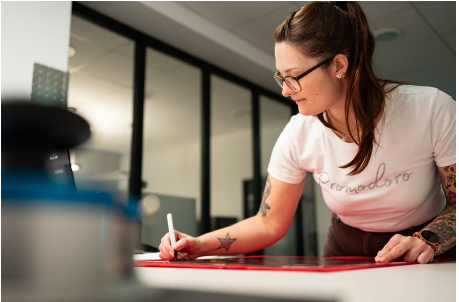
Christina überprüft mit dem Shrinkage Template, genormt nach ISO 6330, die Einlaufwerte.
